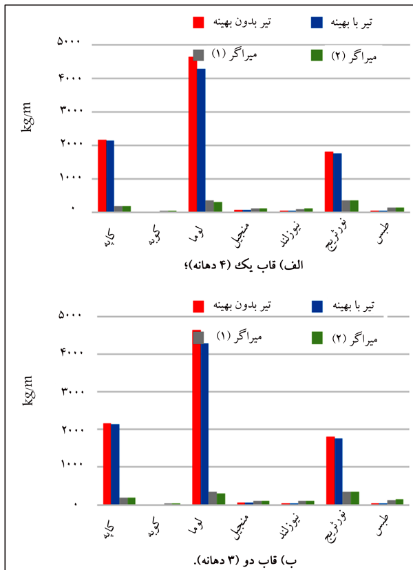
شکل ۱۴. توزیع انرژي المان‌های سازه‌ی ۶ طبقه در حالت ضربه با وجود میراگر ویسکوز قیل و بعد از حذف میراگر.
