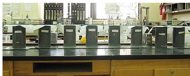
شکل ۴. تصویر سری آزمایش‌های انتشار مولکولی در حال انجام.
