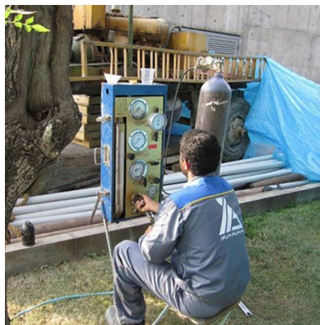
شکل ۳. تصویری از انجام آزمایش پرسیمتری در حالت برجا.
