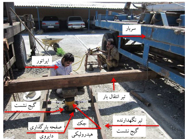
شکل ۱۱. ترانشه و تجهیزات برای انجام آزمایش.
