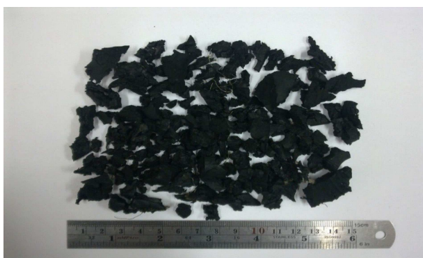
شکل ۲. تصویری از خرده‌لاستیک مورد استفاده در آزمایش‌ها.
