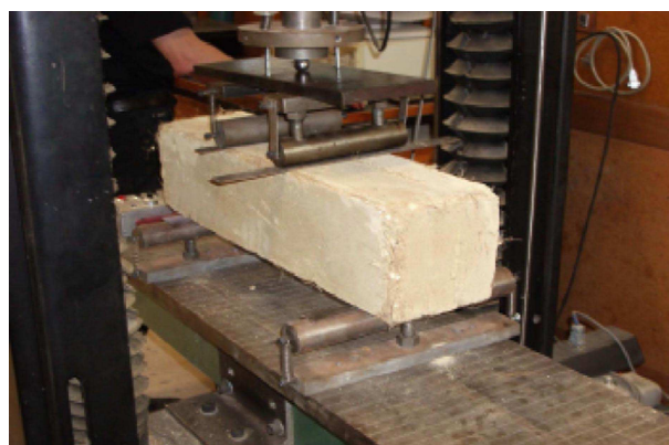
شکل ۳. نمونه‌ی آزمایش خمشی و دستگاه مربوط.
