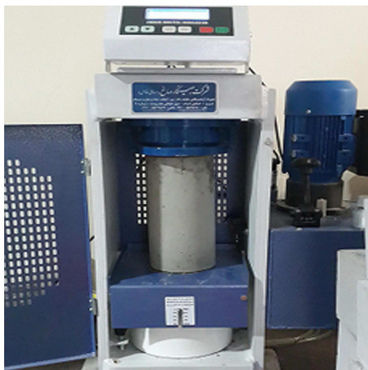
شکل ۲. نمونه‌ی آزمایش فشاری و دستگاه مربوط.
