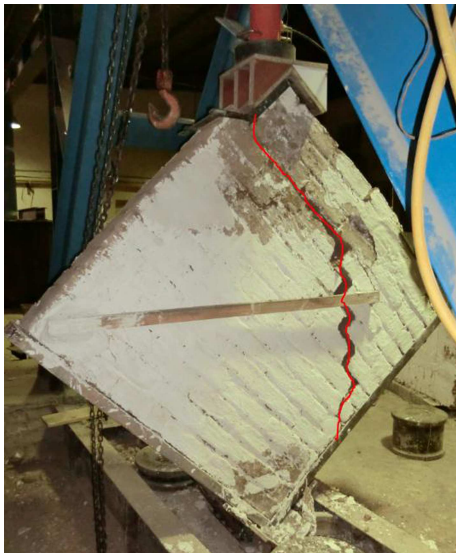
شکل ۱۳. ترک‌های ایجاد شده در دیوار خشتی با ملات ساده پس از آزمایش کشش قطری.
