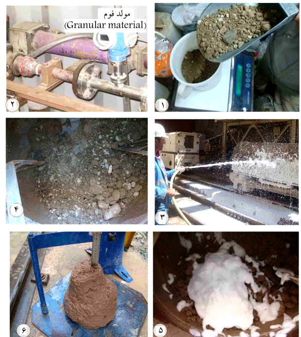
شکل ۲. نمودار جریانی از روند آزمون‌های آزمایشگاهی با هدف ارزیابی کاربردی خاک.
