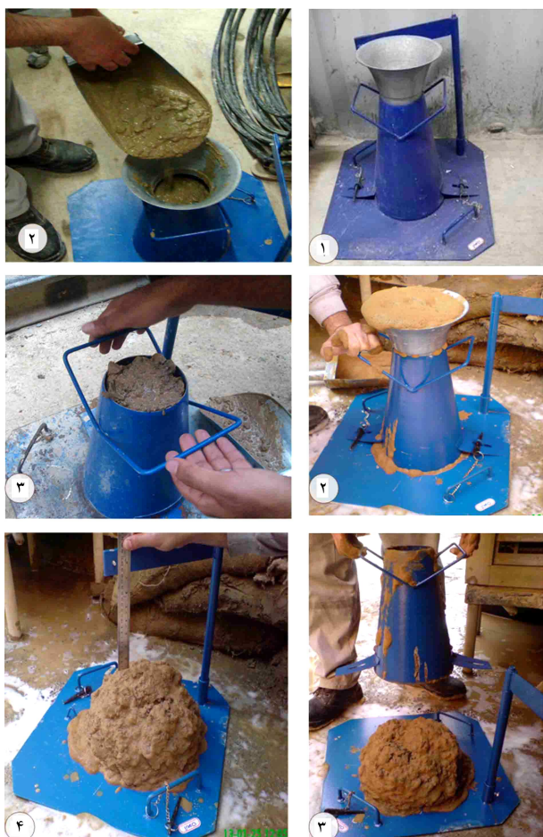
۱- استفاده از مخروط اسلامپ براساس استاندارد ASTM C ۱۴۳
