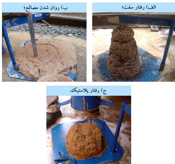
شکل ۶. رفتار متفاوت مصالح به عمل آوری شده در آزمایش اسلامپ.
