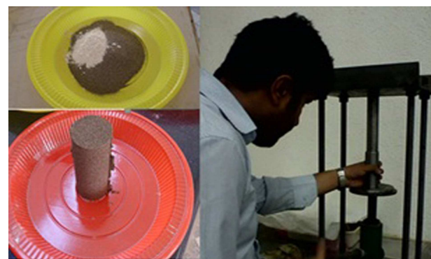
شکل ۴. روند ساخت نمونه‌های آزمایش کششی.
