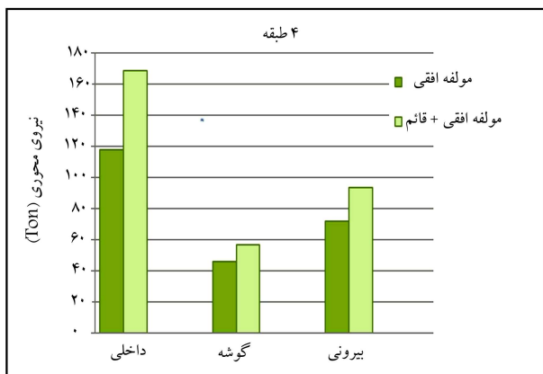
شکل ۱۱. متوسط نیروی محوری ستون‌های گوشه، داخلی و بیرونی طبقه اول در مدل ۴ طبقه.
