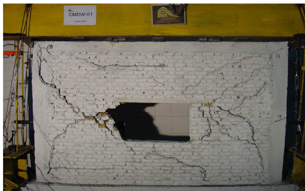
شکل ۶. تصویر نمونه با کلاف پس از اتمام آزمایش. [۷]
