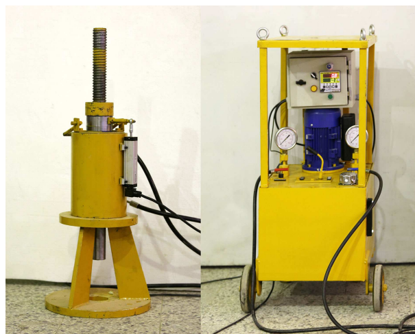
شکل ۲. تجهیزات انجام آزمون کشش انکر.
