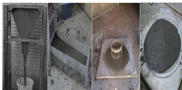
شکل ۲. آزمایش‌های فاز خمیری بتن خودتراکم. (الف) قیف V؛ (ب) جعبه L؛ (ج) حلقه J؛ (د) جریان اسلامپ.
