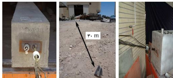
شکل ۱۰. پارگی تاندون‌ها و پرتاب گیره‌های انتهایی.
