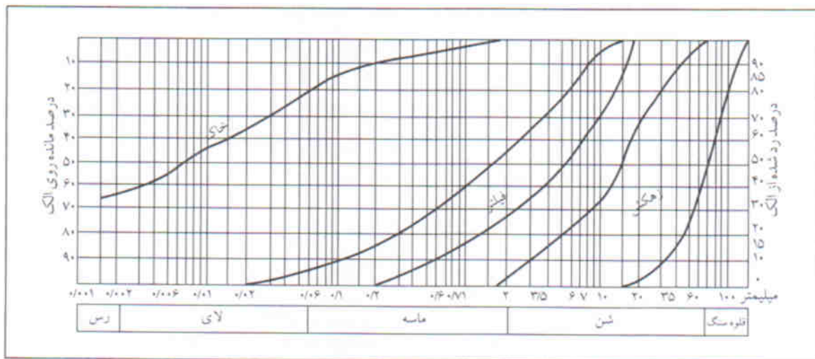
شکل ۵. منحنی دانه‌بندی خاک، فیلتر و زهکش تکیه‌گاه سد خاکی برنجستانک.
