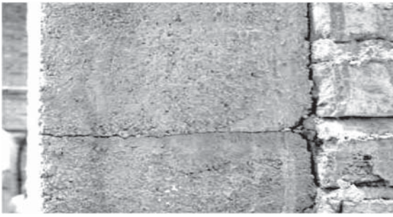
شکل ۱۵. ترک افقی و بازشدگی محدود بین کلاف قائم و دیوار در مرحله اول آزمایش.
