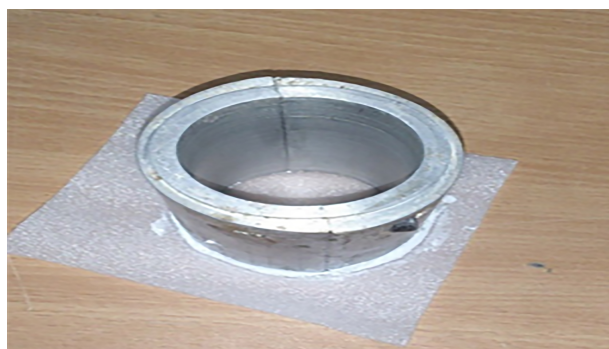
شکل ۴. تصویر قالب عمل آوری نمونه های آزمایش قبل از انتقال به دستگاه انجماد.
