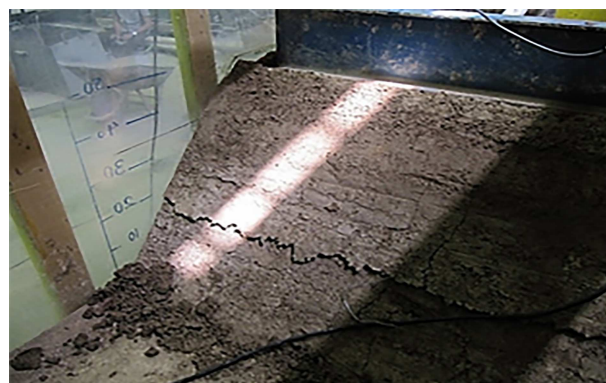
شکل ۱۹. گسیختگی خاکریز ELM2 در ارتفاع ۲۰ سانتی متری از بستر اصلاح شده.
