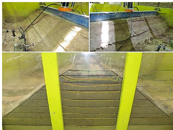
شکل ۲۲. نشست ها و سطوح گسیختگی در خاکریز ELM3.
