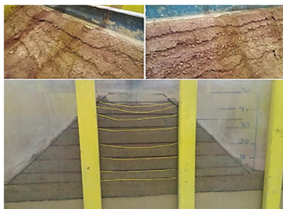
شکل ۱۵. نشست‌ها و سطوح گسیختگی در خاکریز ELM^0 .
