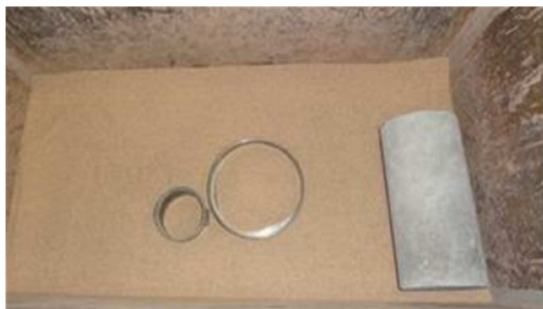
شکل ۲. آزمایش چگالی در محل به منظور رسیدن به تعداد عبور غلتک. [۲۲]
