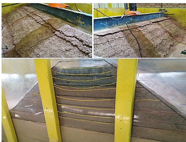
شکل ۲۴. نشست‌ها و سطوح گسیختگی در خاکریز ELM۴.
