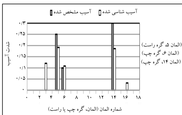
شکل ۱۰. نمودار شناسایی خرابی در حالت G2 و حالت 1 قرارگیری حسگر.
