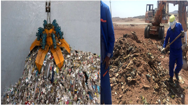
الف) حفاری در محل زباله های سالخورده؛ ب) محل برداشت نمونه های تازه. شکل ۲. نمونه‌گیری از زباله‌های جامد شهری در مرکز دفن.
