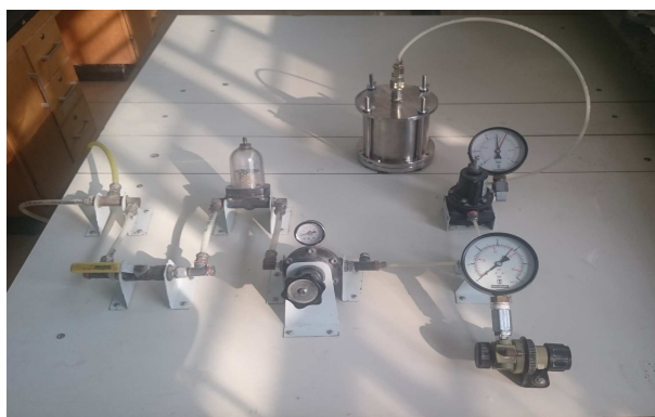
شکل ۵. تصویر دستگاه صفحه‌ی فشاری و پانل کنترل فشار در حین انجام آزمایش تعیین منحنی مشخصه‌ی رطوبتی خاک.
