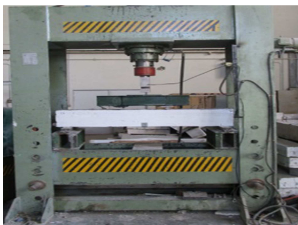
شکل ۱۱. دستگاه بارگذاری و نحوه‌ی بارگذاری نمونه‌ها.
