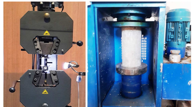
شکل ۳. آزمایش کشش آرماتور و مقاومت فشاری بتن.
