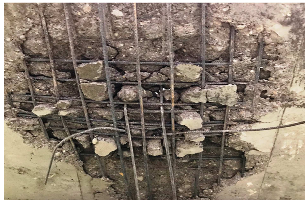
شکل ۱۴. وجه‌های فشاری و کششی نمونه‌ی SB - ۱ در انتهای باربری.
