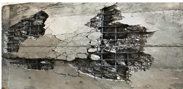
شکل ۱۹. سازوکار گسیختگی وجه‌های فشاری و کششی نمونه‌ی SS-۲.
