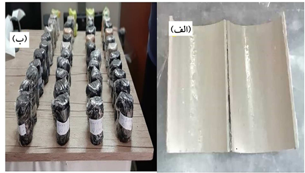
شکل ۴. الف) قالب آزمایش، ب) نحوه ی عمل آوری نمونه ها درون قالب با عایق و پوشش مرطوب.
