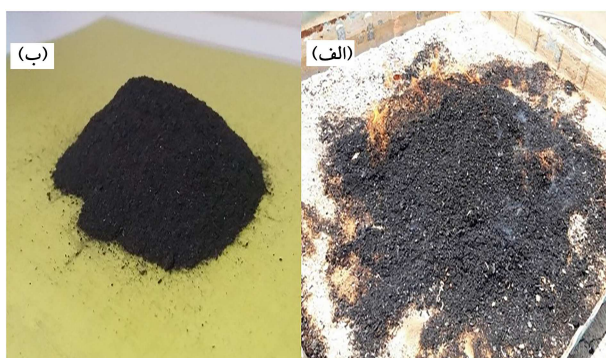
شکل ۳. الف) سوزاندن خاکاره، ب) خاکستر خاک اهری عبوری از الک ۲۰۰.
