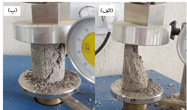
شکل ۵. الف) تصویری از خاک تثبیت نشده، ب) نمونه ی بهسازی شده با ۴٪ سیمان، ۱۰٪ زئولیت و ۵٪ خاکستر خاک اره در لحظه ی گسیختگی.
