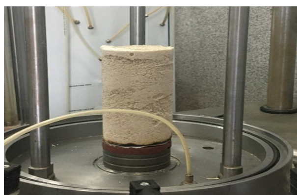
الف) نمونه‌ی تثبیت شده قبل از انجام آزمون سه محوری؟
