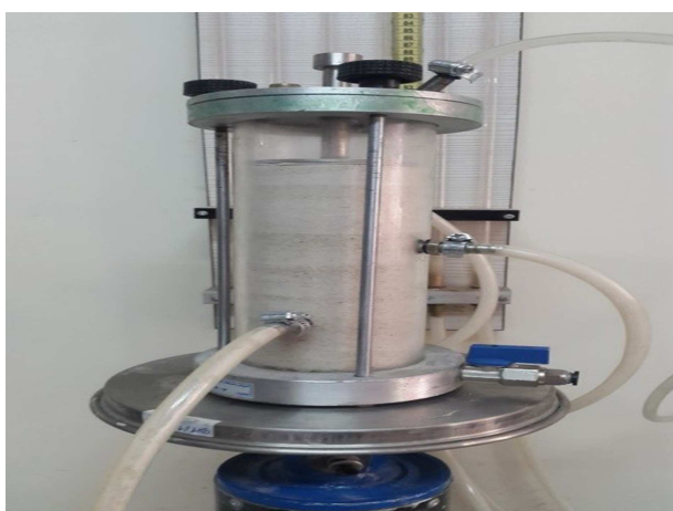
شکل ۱۳. نمونه‌ی تثبیت شده در داخل سل نفوذپذیری.
