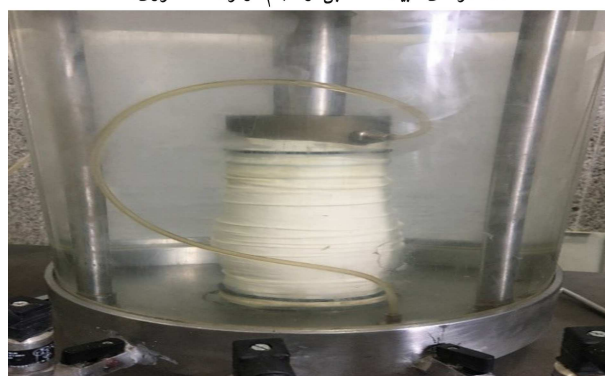
ب) نمونه‌ی تثبیت شده بعد از گسیختگی.
