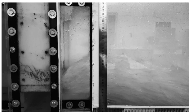
شکل ۶. نمونه‌ی الگوی متلاطم جریان عبوری از زیر دریچه‌ی کنترل درگشودگی ۳۰٪.
