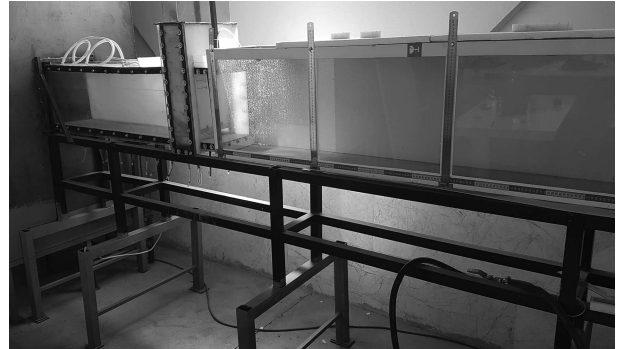
شکل ۲. نمای قسمت‌های مخزن بالادست، مجرای تحت فشار، دریچه‌ی کنترل و مجرای جریان آزاد.
