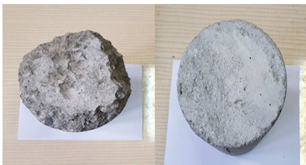
الف) نمونه کنترلی در ابتدای آزمایش؛ ب) نمونه کنترلی پس از اعمال ۳۰۰ سیکل ذوب - یخبندان.
