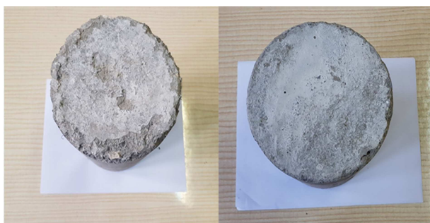
الف) نمونه حاوی نانو سیلیس در ابتدای آزمایش؛ ب) نمونه حاوی نانوسیلیس پس از اعمال ۳۰۰ سیکل ذوب - یخبندان.
