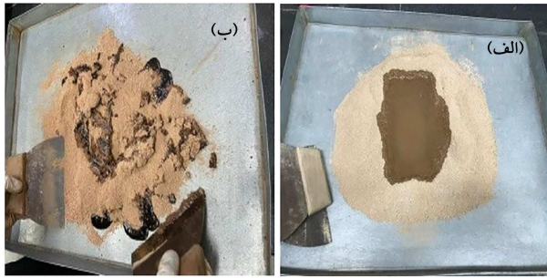
شکل ۲. الف) اختلاط خاک با نفت، ب) اختلاط خاک آلوده با رطوبت بهینه.
