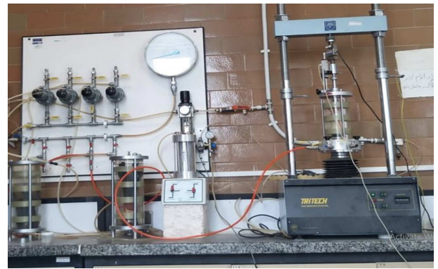
شکل ۶. تصویری از انجام آزمایش نفوذپذیری به کمک دستگاه سه محوری در آزمایشگاه.
