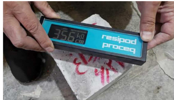
شکل ۷. تعیین مقاومت الکتریکی بتن.
