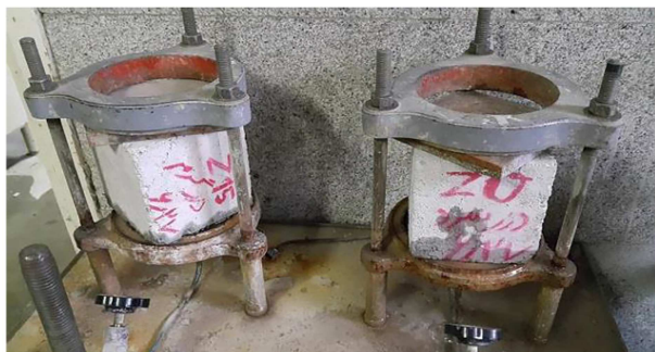
شکل ۵. قرارگیری نمونه‌ها در دستگاه آزمایش عمق نفوذ آب.
