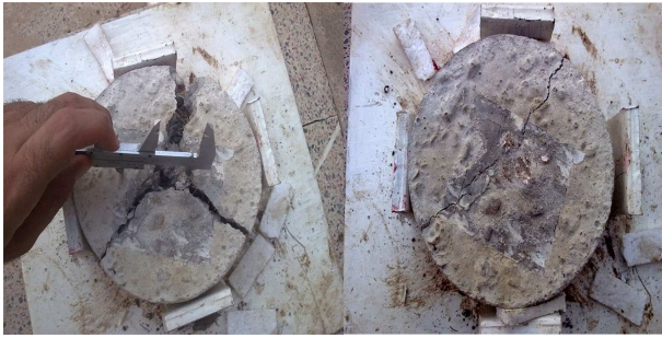
شکل ۸. شکست قطری نمونه‌ی بتن معمولی و شکست قطاعی نمونه با سبک‌دانه.
