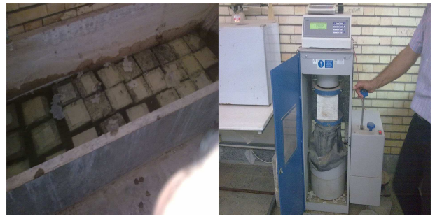
شکل ۷. آزمایش مقاومت فشاری بر روی نمونه‌های مکعبی.
