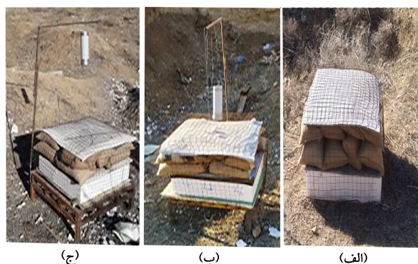
شکل ۵. الف) آزمایش ۱، ارزیابی پلنل به صورت انفجار تماسی؛ ب) آزمایش ۲، ارزیابی پلنل با فاصله‌ی ۰/۲ متری در انفجار، ج) آزمایش ۳، ارزیابی پلنل با فاصله‌ی ۱ متری در انفجار.
