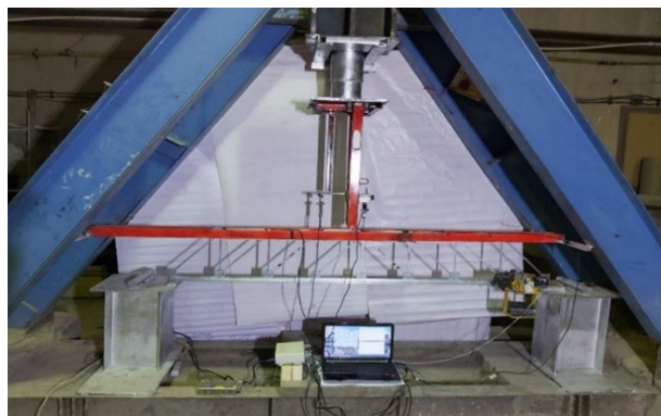
شکل ۱. نمونه‌ی پل خرابایی ساخته شده در آزمایشگاه.
