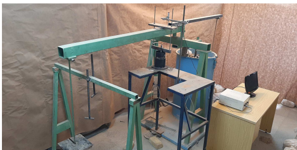
شکل ۵. دستگاه ارزیابی پتانسیل رهمبندگی با قابلیت مدل‌سازی الگوی نفوذ آب.
