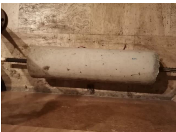
شکل ۵: نمونه بتن مسلح استوانه‌ای
