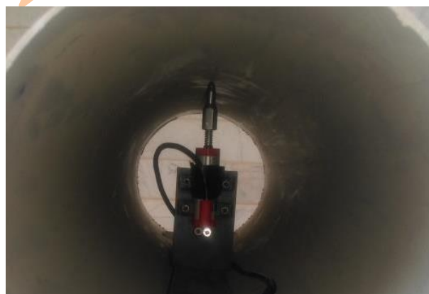
شکل ۲: تصویری از حسگر سنجش تغییر مکان و نصب آن داخل لوله
