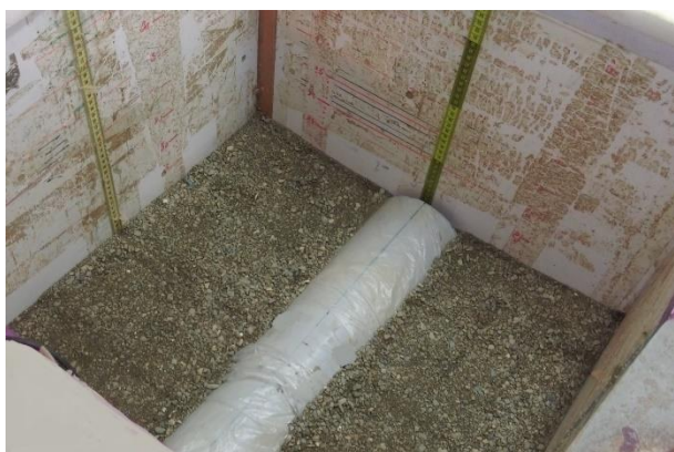
شکل ۳: تصویری از لوله حین آماده‌سازی آزمایش
