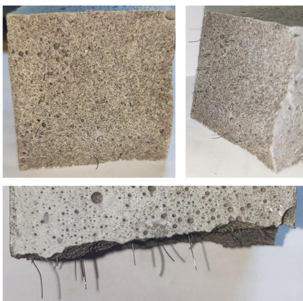
شکل ۷: باقت کامپوزیت سیمانی M5 پس از آزمایش خمش سه نقطه‌ای.
