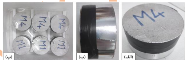
شکل ۳: (الف) نمای سه یعدی سطح جانبی و فوقانی نمونه عایق‌بندی شده، (ب) نمای جانبی و (پ) تصویر آزمایش جذب آب مویینه.
