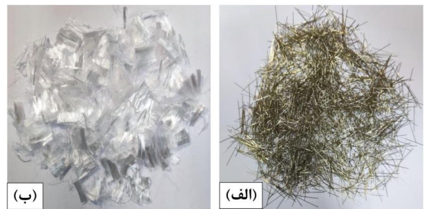
شکل ۱: تصاویر ظاهری میکروالیاف مصرفی: (الف) میکروالیاف فولادی و (ب) میکروالیاف پلی‌پروپیلن.
