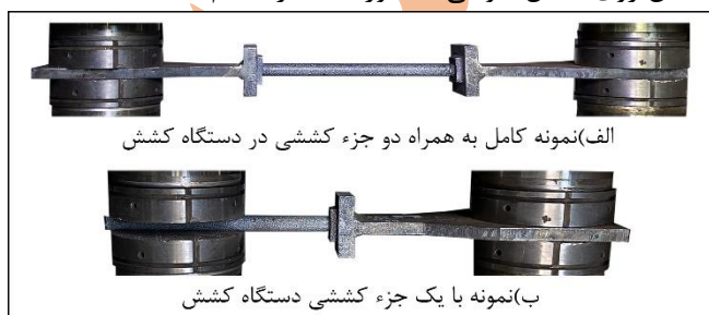
شکل ۱۴: نمونه‌های آزمایشگاهی در مرحله اول و دوم تست کشش
