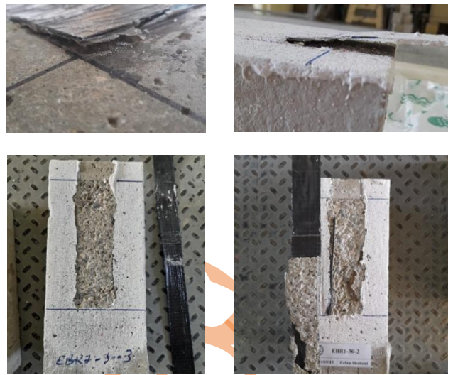
شکل ۷- نحوه‌ی گسیختگی نمونه‌های؛ (الف) S30-1؛ (ب) S30-2
