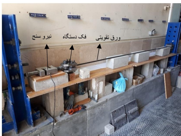
شکل ۲- چیدمان نمونه‌ها در دستگاه پیش تنیدگی
