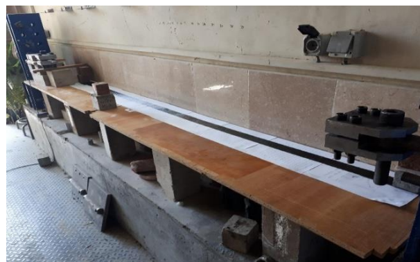
شکل ۱- دستگاه پیش تنیدگی به همراه FRP بریده شده
