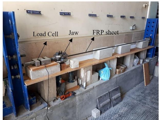
شکل ۵.۲. چیدمان نمونه‌ها در دستگاه پیش تنیدگی.
