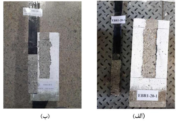
شکل ۶. نحوه گسیختگی نمونه‌های: (الف) S۲۰-۱؛ (ب) S۲۰-۲.
