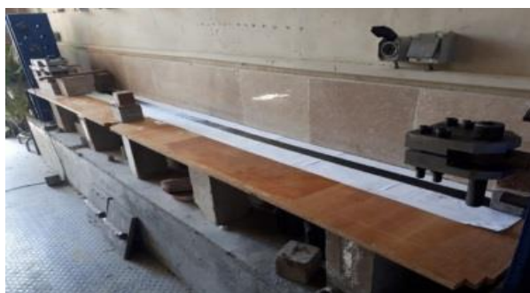
شکل ۱. دستگاه پیش‌تنیدگی به همراه FRP بریده‌شده.
