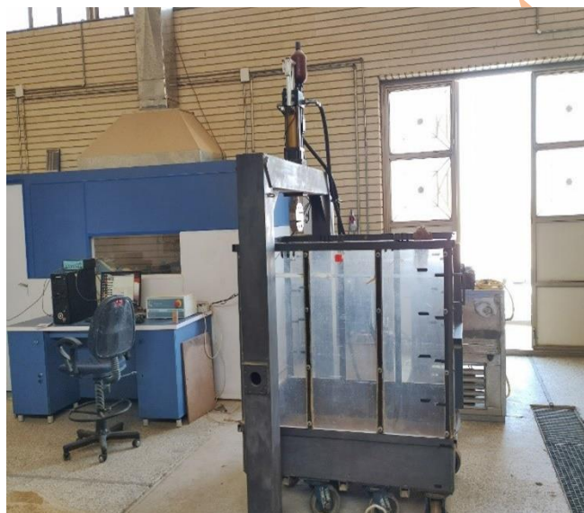
شکل ۴. جعبه مدلسازی بزرگ مقیاس موجود در دانشگاه صنعتی شاهرود
