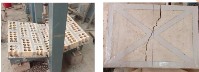
شکل ۸: تصویر شکست دیوار W_3 (نمای جلو و پشت دیوار)
