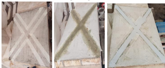
شکل ۳: نمایی دیوار W ۲ (از چپ به راست): کادر بندی دیوار؛ پوشش پرایمر؛ پوشش اصلی (طوسی)
