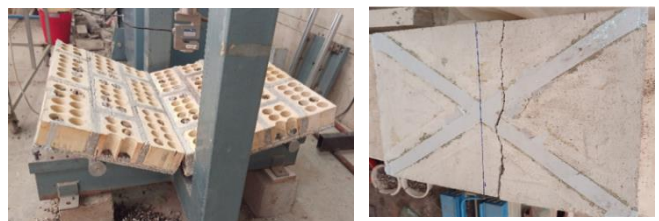
شکل ۷: تصویر شکست دیوار W_2 نمای جلو و پشت دیوار
