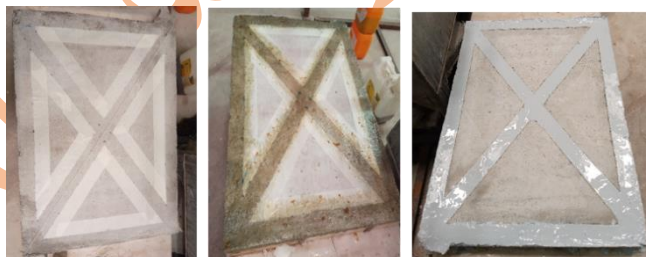
شکل ۲: نمایی از دیوار W ۳ (از چپ به راست): کادر بندی دیوار؛ پوشش پرایمر؛ پوشش اصلی (طوسی رنگ)
