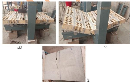
شکل ۶: الف) نصب دیوار W_1 در دستگاه خمشی ب) شکست دیوار پس از اعمال بار ج) نمای پشت دیوار شکسته شده
