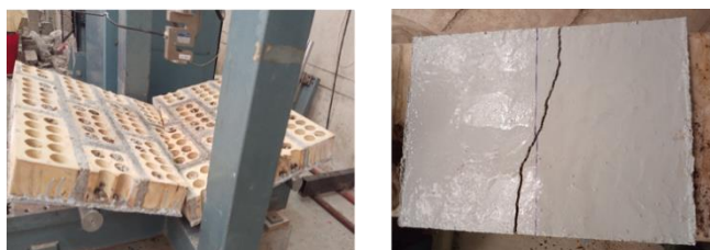
شکل ۹: تصویر شکست دیوار W4
