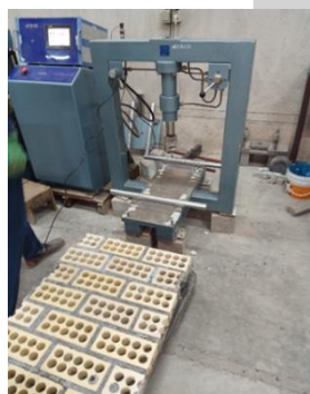
شکل ۵: نمایی از اجرای دستگاه خمشی چهار نقطه‌ای
