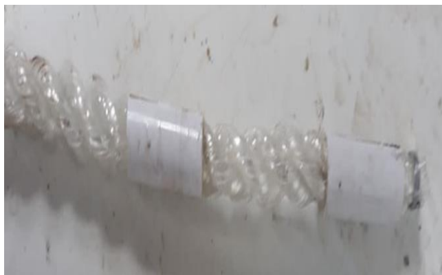
شکل ۲: نمونه‌ای از طناب بافته شده از پلی‌اتیلن ترفتالات
