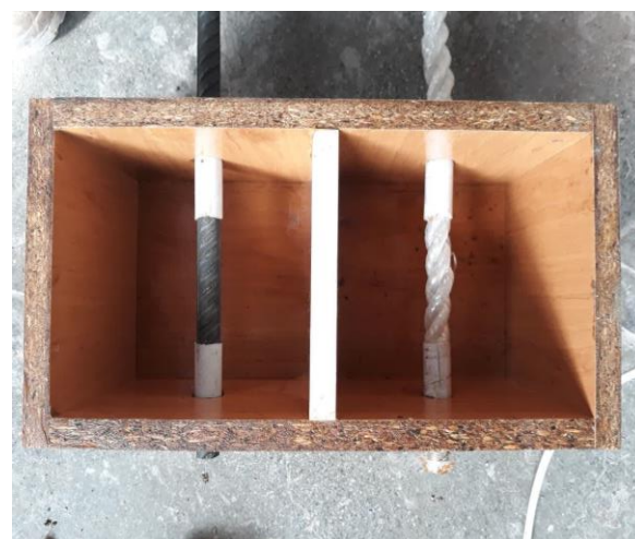
شکل ۳: مشخصات هندسی نمونه بیرون کشیدگی و نمونه ساخته شده
