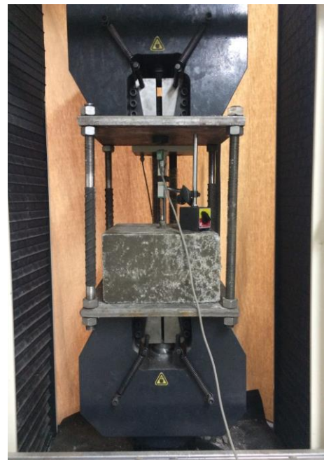
شکل ۴. آزمایش بیرون کشیدگی میلگرد و نحوه‌ی قرارگیری حسگر جابجایی سنج.
