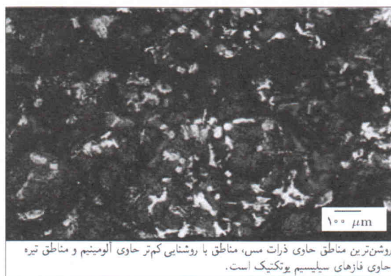
شکل ۱۳. تصویر BE حاصل از سطح مقطع شکست نمونه عملیات حرارتی شده T_6 .
