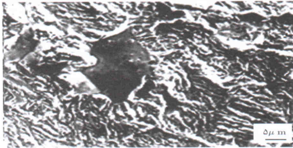
شکل ۷. تصویر SEM نشان دهنده‌ی تشکیل خطوط امواج خستگی در ساختار فریت - بینیت.
