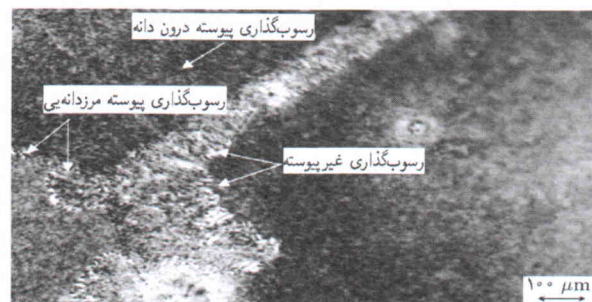
شکل ۲. رسوب‌گذاری توأم پیوسته و غیرپیوسته در آلیاژ AZ91 که به مدت ۶۴ ساعت در 165^\circ\text{C} پیر شده است.
