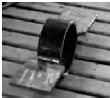
شکل ۱۰. حلقه‌ی فولادی جوش شده به صفحات اتصال.
