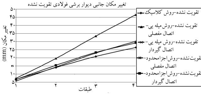
شکل ۱۷. نمودار تغییر مکان جانبی دیوار برشی فولادی تقویت نشده [۱۹].
