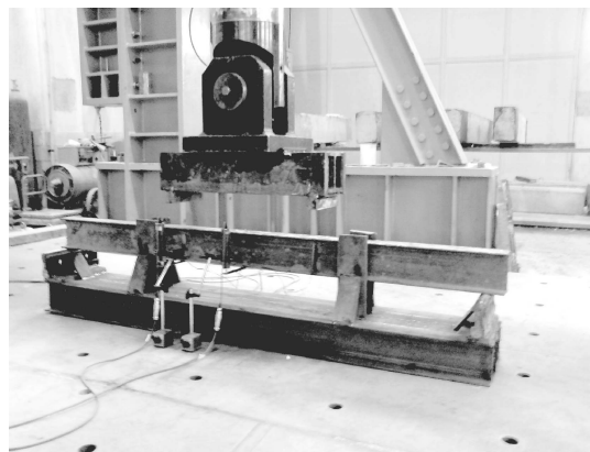
شکل ۲. نحوه‌ی بارگذاری تیر در قاب.
