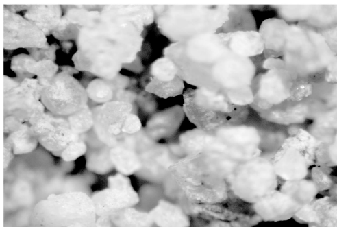
ب) عکس میکروسکوپی ماسه دارای ۱۵ درصد رس با خاصیت خمیری بالا (MF: 40X-6X, 1/45).
