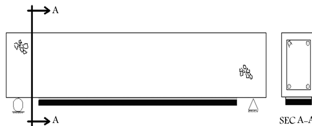
شکل ۱. تیر بتن آرمه‌ی تقویت شده با ورق ساده‌ی FRP در وجه کششی.
